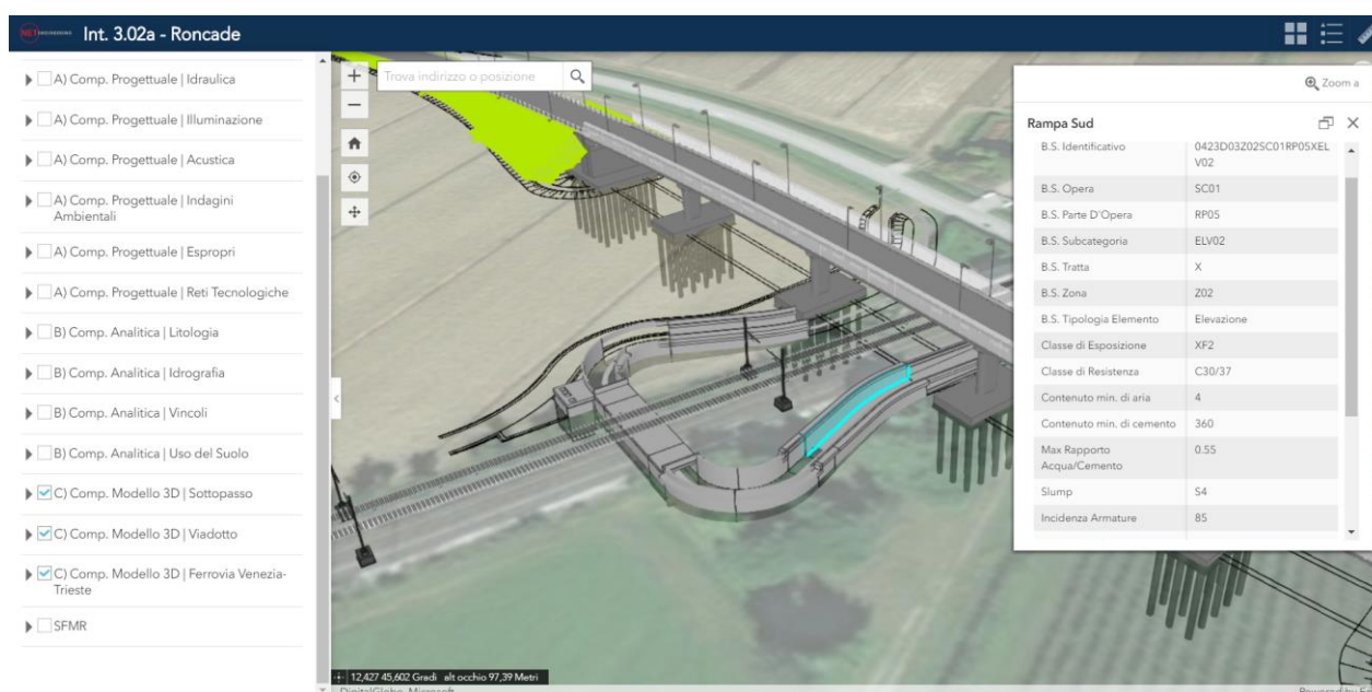
Figura 3. Le componenti progettuali tridimensionali e le P.B.S. BIM importate da Revit (NET Engineering).
